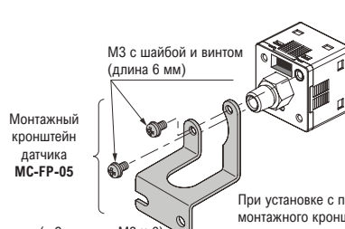
Установка крепежного кронштейна датчика MS-FP-05
